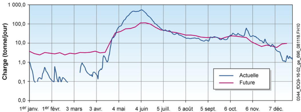
Figure DQ9-16-2 : Distribution annuelle de la capacité de transport de la charge de fond au PK 3,2
